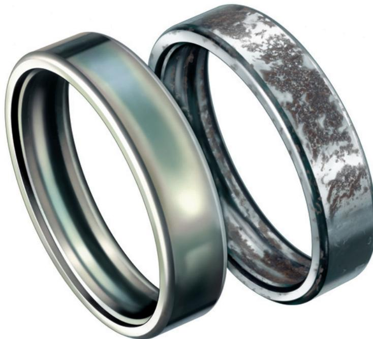
Anéis dos rolamentos após teste de *Salt Spray*.
