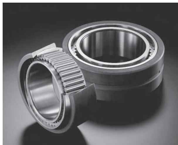
■ Rolamentos de rolos cilíndricos de complemento total com anel de auto-alinhamento (para rolos guia de fábricas de fundição contínua) (CAT. NO. 165E)
